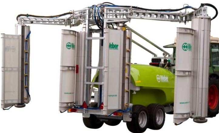
WEBER – descentes avec panneaux récupérateurs
